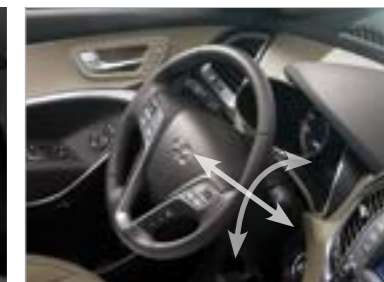
Vô lăng điều chỉnh 4 hướng Vô lăng có thể điều chỉnh nghiêng hoặc ra/vào cho phép bạn tìm được vị trí điều khiển thoải mái nhất.
